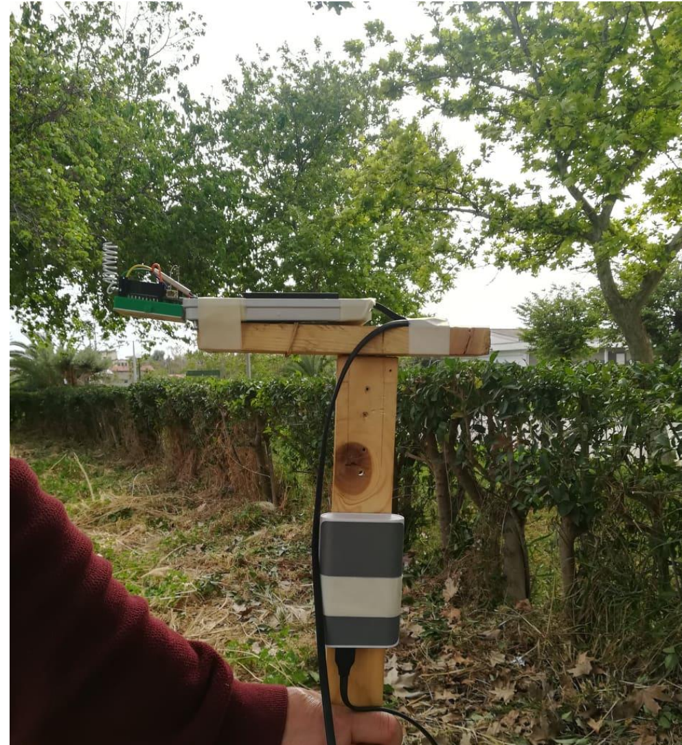
Εικόνα 3. LoRa κόμβοι κατά τη διάρκεια πειραμάτων. Ψηφιακή Γεωργία
