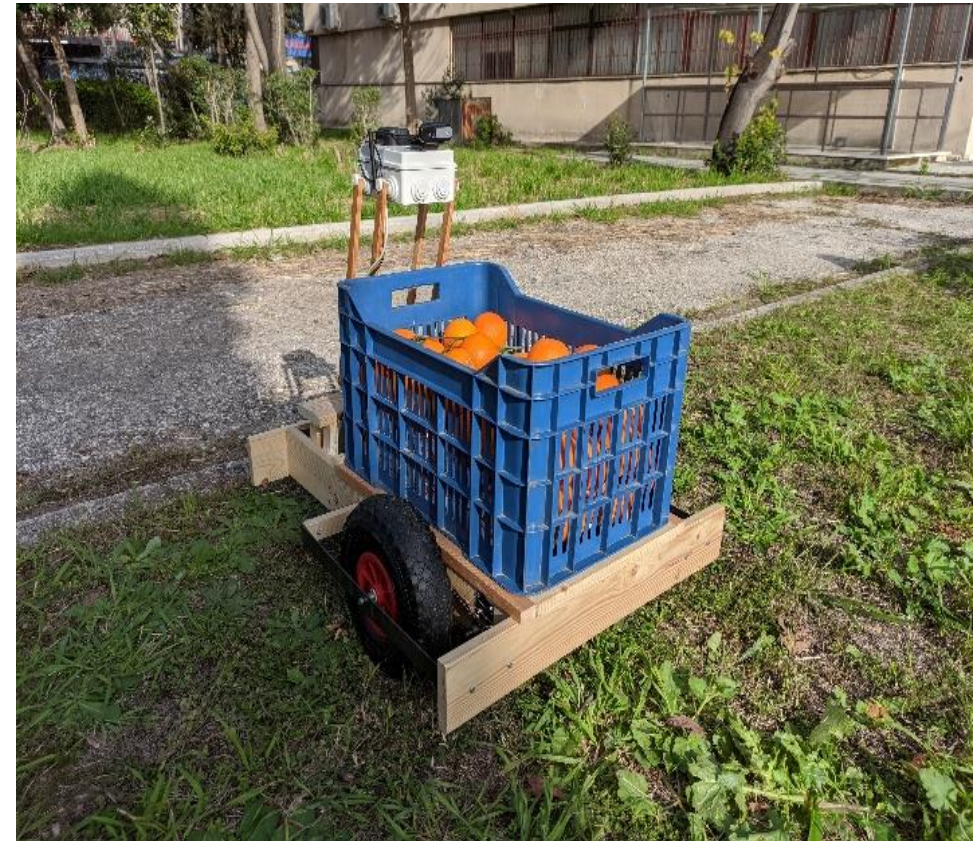
Εικόνα 1. Ρομποτικό ψεκαστικό όχημα (Αριστερά), Ρομποτικό όχημα με καλάθι – ακόλουθο του αγρότη (Δεξιά).
