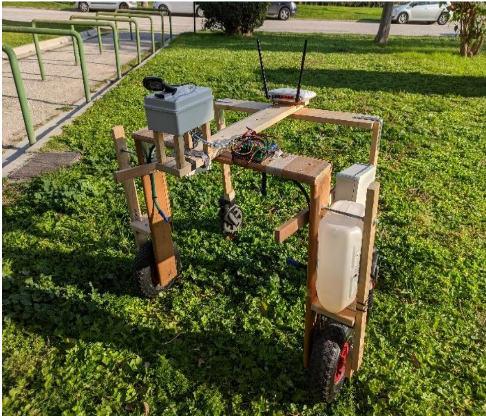
Εικόνα 1. Ρομποτικό ψεκαστικό όχημα (Αριστερά), Ρομποτικό όχημα με καλάθι – ακόλουθο του αγρότη (Δεξιά).
